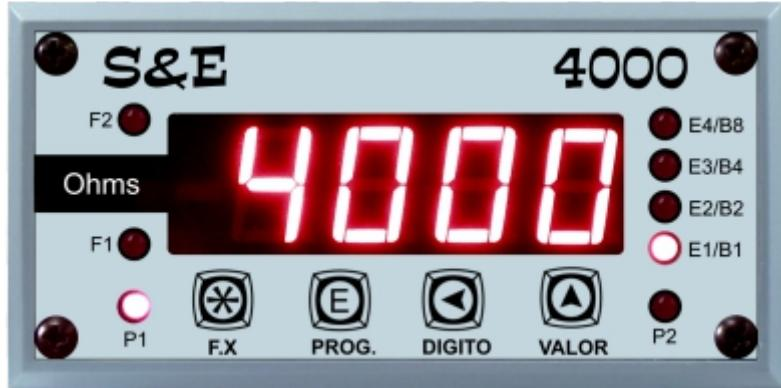
O Ohmímetro digital MDR-4000 é um instrumento destinado a medição de resistência diversas em sistemas automáticos que necessitam de set points, para programação de limites de tolerância de erro (valor mínimo e valor máximo) para sinalização ou comando de seleção externa, acionando por exemplo válvulas, comportas ou desvios de peças fora do padrão.
