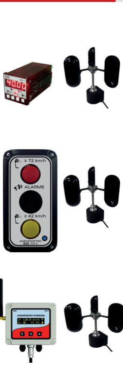
**Anemômetro AN-1C:** possui indicador digital para painel com 2 presets de velocidade do vento. Pode ser configurado para indicar em km/h, m/s ou knots (nós). Com alarme sonoro e saída analógica em 4 a 20mA ou 0 a 20mA configurável.
